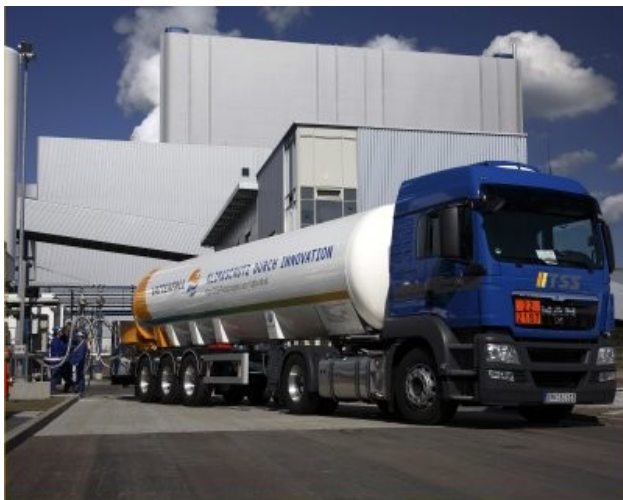
Trailer für den CO 2 Transport
